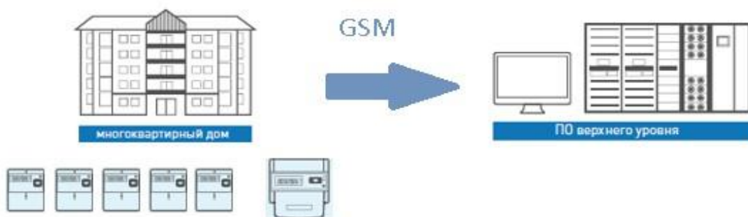
Рис. 1 Организация ИСУ в МКД на базе GSM.
